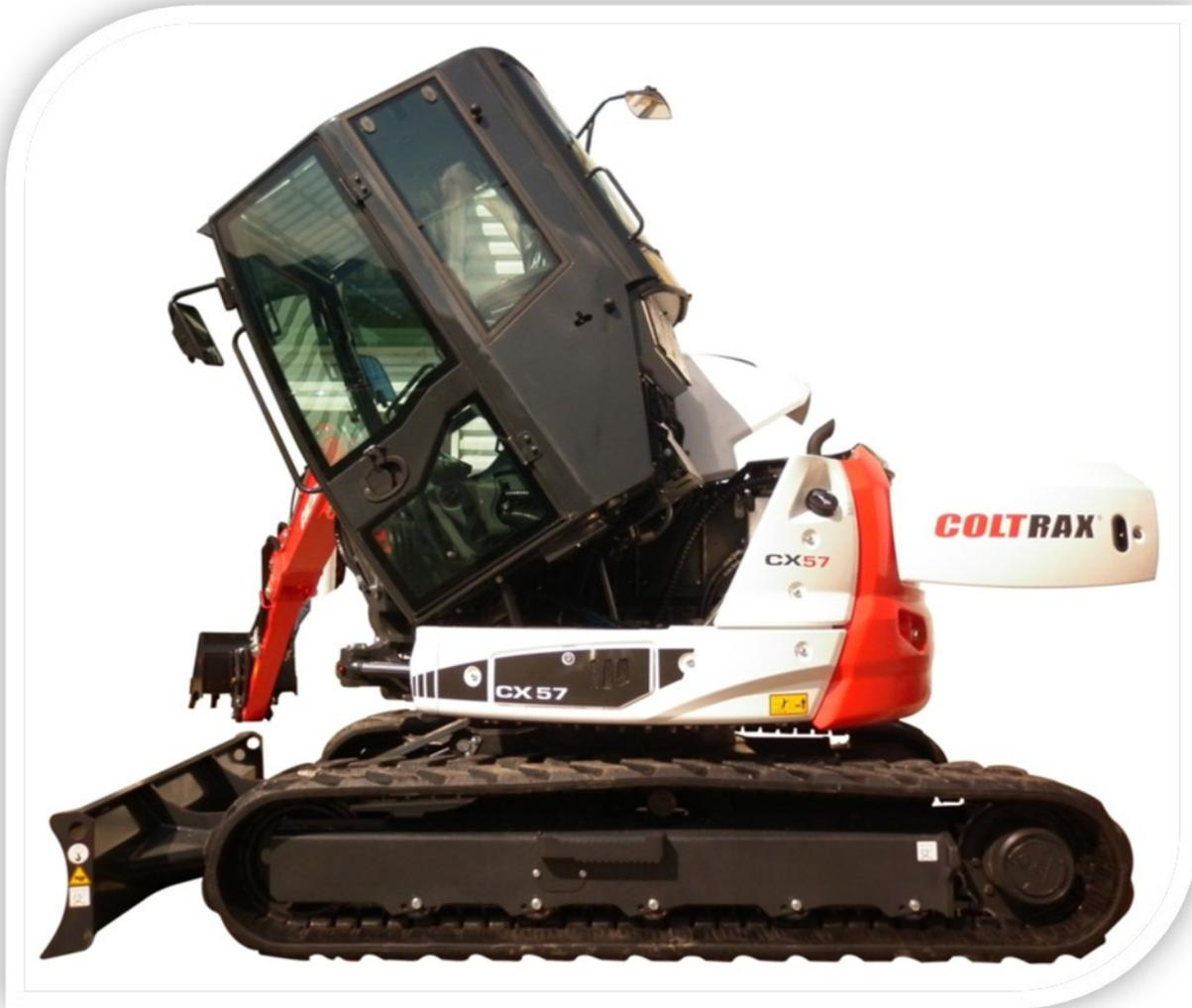
Le capot AR de la machine offre une accessibilité optimale pour l'accès au distributeur. La pompe à Gazole est de série sur les modèles CX 57 et CX 60.
